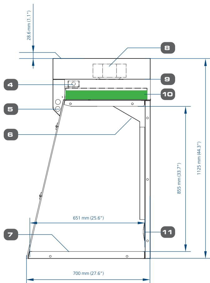
7. Radna ploča od nerđajućeg čelika
